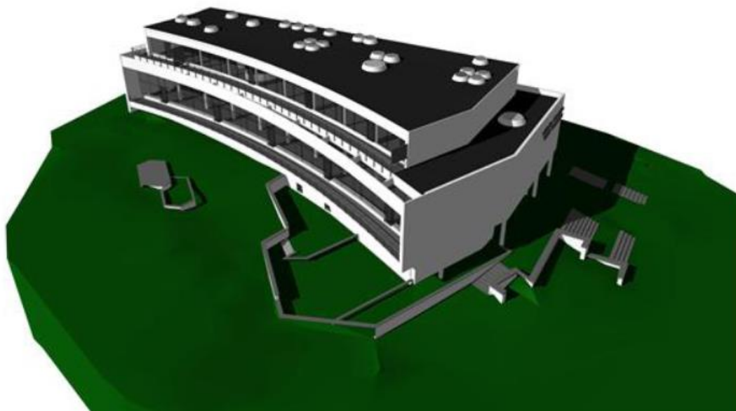
Joonis 4. Teise taseme ehitise osade mudel on mõõdistusmudeli loomise baastase, kus ruumid modelleeritakse ruumielementidena koos oma ruumitunnuse ja kõigi ehitise osadega. Kolmanda taseme ehitise osade mudelile lisanduvad dekoratiivelemendid, sisustus ja pinnatekstuürid. Töölo raamatukogu, Helsinki linn. Joonis: Tietoa Finland Oy
