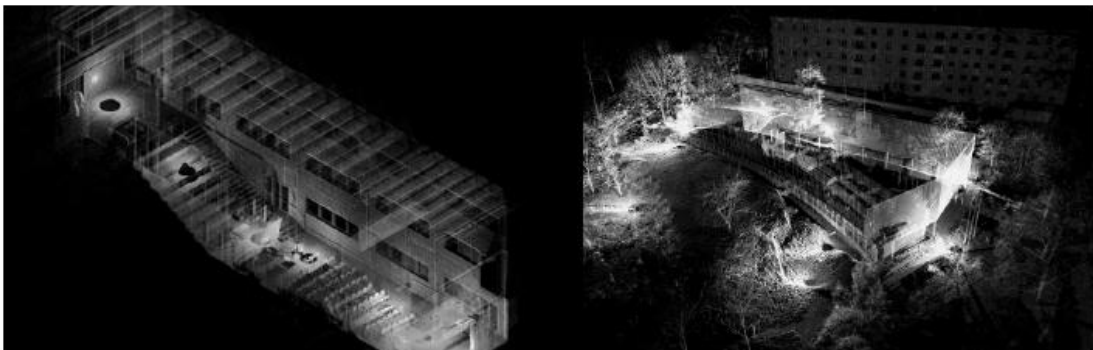
Joonis 7. Vasakul sisemõõdistamise ja paremal välimõõdistamise laserskaneerimise punktipilve mudel. Joonis: Tietoa Finland Oy.
