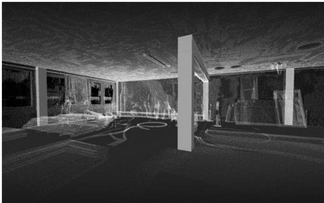
Joonis 6. Ehitusstaadiumis tehtud lisamõõdistamiste punktipilvemudel. Joonis: Tietoa Finland Oy.
