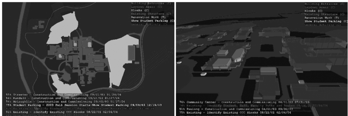
Joonis 6.12. Väljavõte 4D mudelist, mis vaatleb ülikoolilinnaku projekti, milles erinevad ehitustööd leiavad aset üle terve linnaku ja erinevate tööde ülesannetena nagu maastiku planeerimine, teede- ning hoonete ehitus. Need väljavõtted aitavad tellijat ning linnaku kasutajaid informeerida, mismoodi on mõjutatud parkimine, sõiduteede kasutus ning ligipääs kindlate hoonete juurde (allikas: Eastman et al., 2011; lk. 284, DPR Construction).
