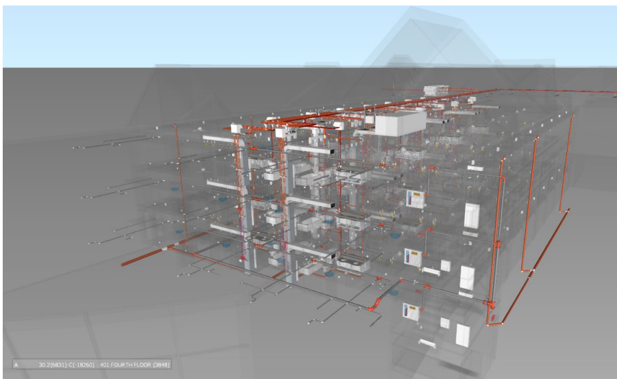
Joonis 7.14. Tehnosüsteemid vaadelduna hoones kui tervikus (allikas: Autodesk Navisworks mudel).
