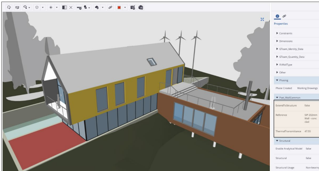
Joonis. Valitud seina (pildil kollane) U-väärtus on 47.55 W/m 2 K (vaadatuna IFC vaatusis, Trimble Connect )
